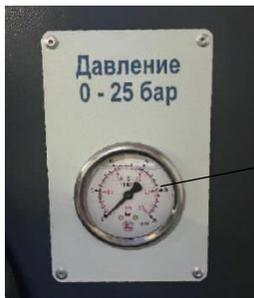
Рисунок 3.2 – Манометр
