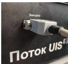
Рисунок 2.2 – Подключение кабеля энкодера
